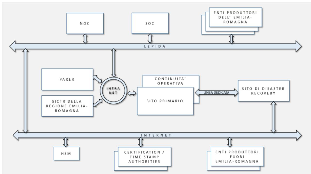
**Figura 10 - Schema Infrastrutturale del Sistema di conservazione**
