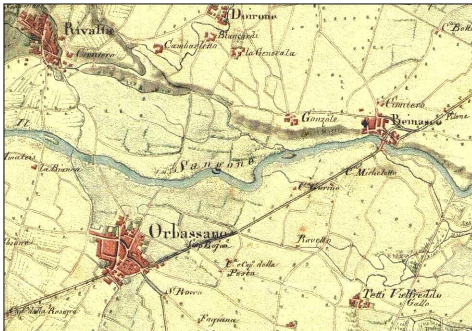
Figura 2-4. Dettaglio del tronco di T. Sangone nella rappresentazione della Carta degli Stati Sardi (edizione 1819, Foglio M.10) che conferma la stabilità planimetrica dell'alveo.
